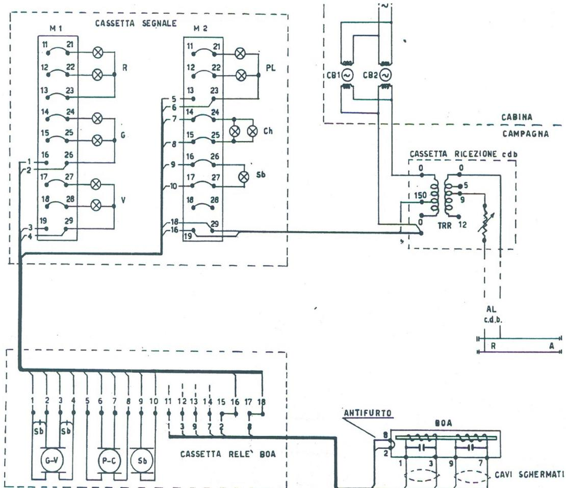
Nel caso in cui la BOA venga rimossa si interrompe il circuito facente capo ai morsetti 2 - 8 della BOA stessa con conseguente occupazione del c.d.b. causata dall'interruzione del circuito di ricezione. L'anomalia viene denunciata sul B.M. Della stazione e sul quadro sinottico del Dirigente Centrale.
